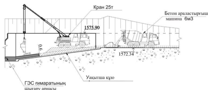
2.2-Сурет ГЭС ғимаратының бұрғыш каналын бетондау және қуыстарын топырақпен толтыру сұлбасы
